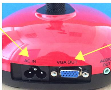
2. Connecter le visualiseur à un vidéo projecteur avec un câble VGA en utilisant la sortie « **VGA OUT** » du visualiseur.
